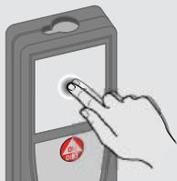
Toccare una volta il display per aprire un pulsante a video o eseguire una selezione. Toccando l'icona posta al centro della riga in basso si attiva la misura della distanza o la fotocamera.
