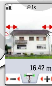
Selezionare le frecce con i tasti cursore o toccando il display e regolare con i softkey. Viene calcolata la larghezza.
