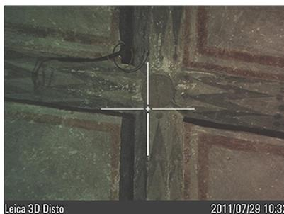
L'altra applicazione che si è potuta sperimentare è quella della sezione automatica in direzione verticale, per la definizione del profilo dettagliato delle murature e delle volte; dalla stessa posizione centrale si è fatta partire la ripresa automatica di misure con intervallo da 1 a 50 cm a seconda della complessità delle superfici, che ha dato come risultato di fatto una sezione a "fil di ferro" passante per il piano verticale definito dal raggio laser.
